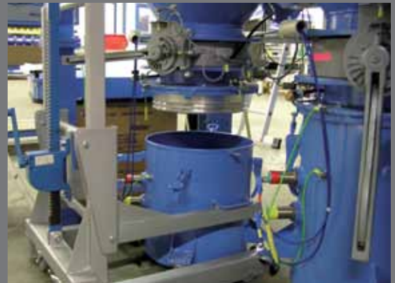
Hubwagen zum sicheren Staubtopfwechsel
