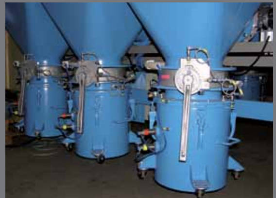
Staubsammeltopf mit Kontaktsensoren
