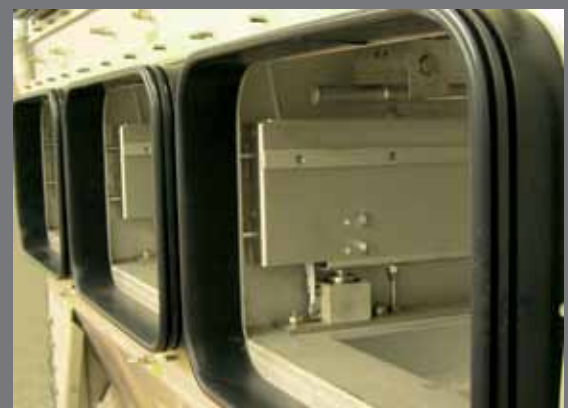
„Safe Change“ Wechselkragen für Filterkassetten
